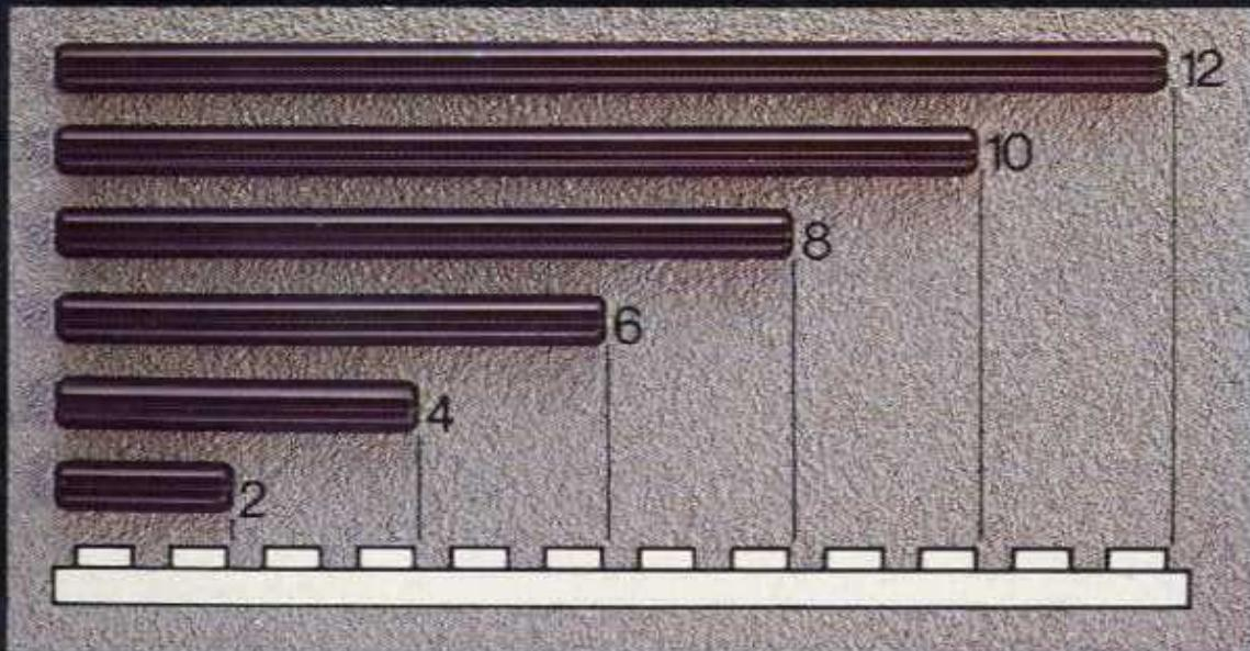
In der Bauanleitung steht vor den Achsen eine Zahl, die die benötigte Länge der Achsen anzeigt.
