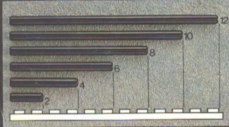
In der Bauanleitung steht vor den Achsen eine Zahl, die die benötigte Länge der Achsen anzeigt.
